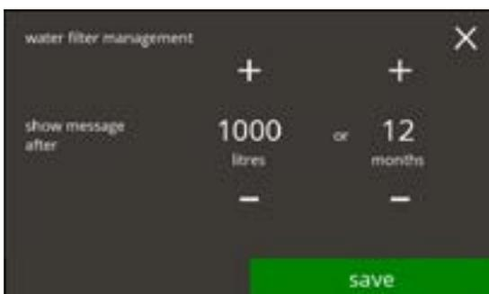
Die Meldung „Wasserfilter ersetzen“ einstellen:
